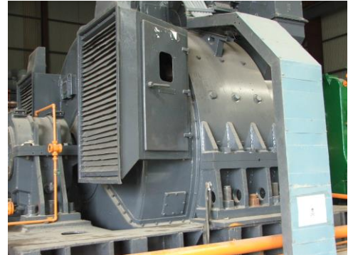
Điều khiển động cơ cán nguội DC 1800kW
